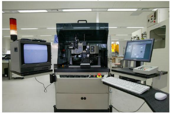
デバイスを微細加工するための装置です。有機高分子材料、セラミック系材料、ガラス、金属薄膜など色々な材料の基板上にレーザーを照射し、その照射部分のみを削ることが可能です。様々な加工実験や試作開発に利用できます。
