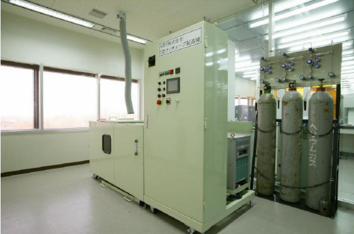
この装置を用いることで、カーボンナノチューブを製造することができます。新しい電極材料や高強度材料、酵素などの新しい担体の作製、ナノバイオセンシングデバイスやナノドラッグなどへの応用が可能です。
