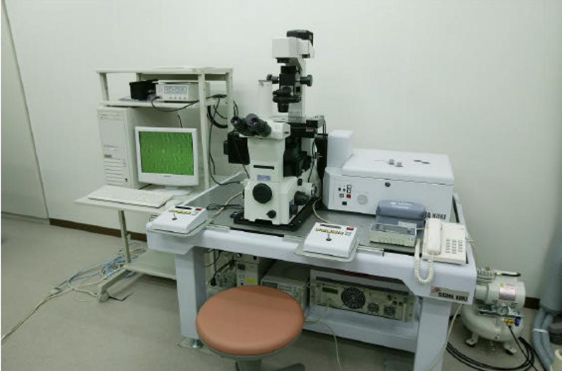
マイクロマニピュレーションシステムは、レーザービームの持つ放射圧を利用して細胞やDNAなどの生体分子を非接触で捕捉することが可能な装置です。マイクロ稼動デバイスの開発、ナノバイオセンシング技術の開発、タンパク質相互作用の知見を獲得できます。
