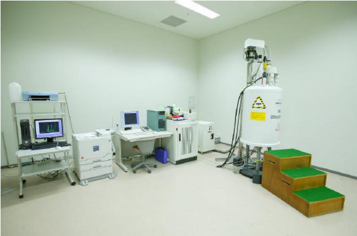
磁場の中で原子核に外部からラジオ波を加え、共鳴現象を起こすことで化合物の構造を調べる装置です。DNAや酵素などの生体分子の相互作用や、その機能を調節・阻害する天然物や合成化合物の構造解析に用いられます。
