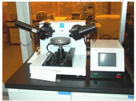
エリプソメトリ (偏光解析)の原理を利用し、薄膜の膜厚と屈折率を高速でかつ高精度に 測定することができる自動エリプソメータです。タッチパネル式の専用コントローラを採用 していますので、簡単な操作で測定することができます。
