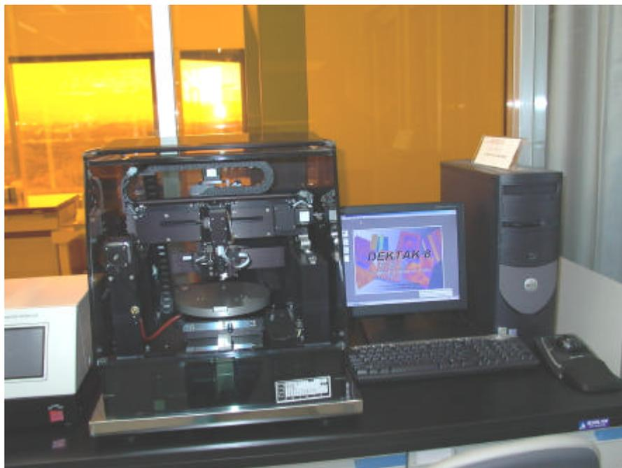
コンパクトなベンチトップデザインを採用した 8 インチウェーハ対応の触針式表面形状測定器です。ユニークなオーバーヘッド式のプログラマブル X,Y ステージにより、測定位置をプログラムすれば最高 200 ポイントまで自動測定が可能です。
