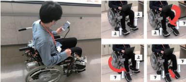
車椅子(カワムラKA22-40SN)にフットペダルを用いた方向制御車椅子用電動ユニット(YAMAHA JW-I)を取り付けたシステム
